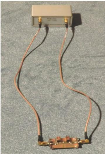
Dann sollte man **zwei identische Teflon-SMA-Kabel mit je 40 cm Länge und nur 2.5 mm Dicke** als dauerhafte flexible „Messadapter“ oder „Messleitungen“ verwenden, die an einem Ende einen geraden SMA-Stecker, am anderen Ende einen abgewinkelten SMA-Stecker tragen. So macht es keine Mühe, richtig an das Messobjekt heranzukommen, ohne die Kabel arg zu verbiegen oder Druck auf die Buchsen beim Aufschrauben der SMA-Stecker auszuüben.
