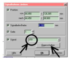
Ist alles OK, dann wird entweder auf die so markierte Signalleitung doppeltgeklickt oder nacheinander "w" und "ä" gedrückt. Es öffnet sich das Menu "Signalbahnen ändern" und wir geben diesem Signal an der gekennzeichneten Stelle den neuen Namen "+5V".
