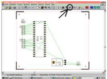
Wir drücken erst die "Taste mit dem IC drauf" (= Bauteile platzieren).
