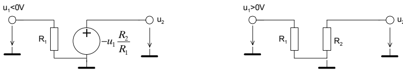
Bild 1-34: Ersatzschaltbilder für das statische Durchlass- und Sperrverhalten des aktiven Einweggleichrichter nach Bild 1-33.
