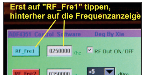
Bild 5: So wird die ausgegebene Frequenz programmiert: erst auf „RF_Fre1“ tippen, bis das Feld blau wird ...
