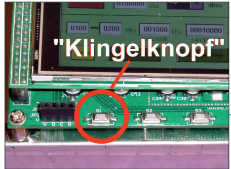
Bild 7: Wenn und solange diese Taste gedrückt wird, gibt das Board „RF_Fre2“ aus
