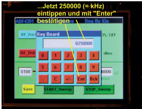
Bild 6: ... und anschließen die gewünschte Frequenz in kHz eingeben
