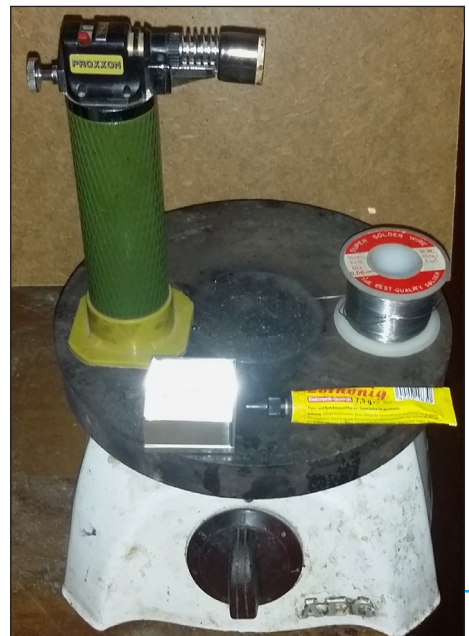
Bild 20: Die kleine Weißblech-Gehäusewerkstatt besteht aus einer alten Elektro-Kochplatte, einer handlichen Proxxon-Gaslötlampe, einer Rolle SMD-Lötzinn mit 0,5 mm Durchmesser, einer Tube Löthionig - darauf wartet schon ein Weißblechgehäuse, das vor Freude „strahlt“
