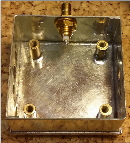
Bild 21: So sieht es im Inneren der ersten Gehäuseversion mit 4 eingelöteten Stehbolzen aus (siehe Text)
