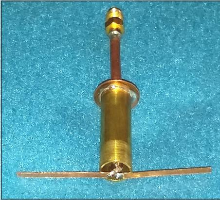
**Bild 29:** Es gilt dasselbe Strickmuster wie beim Kreuzdipol: Semirigid-Kabel / Symmetrierung durch Sperrtopf / Antenne
