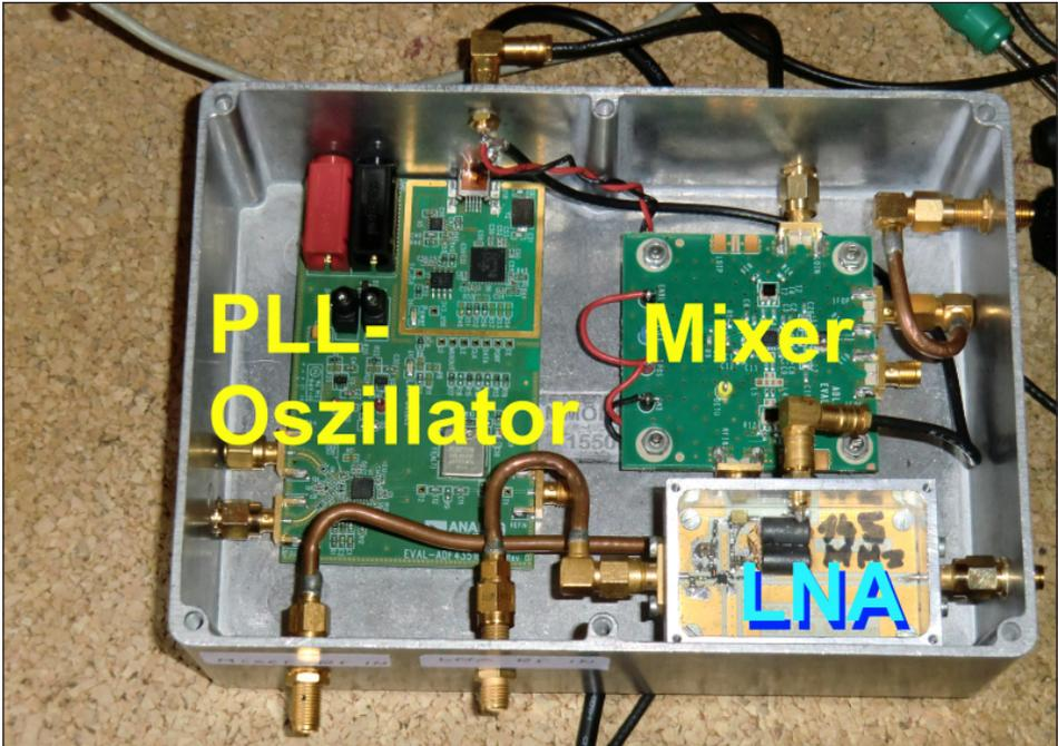
*Bild 42: Sicher ist sicher: lieber zu viel als zu wenig Abschirmung; nur so kommt man zuverlässig herunter bis zu kleinsten Eingangspegeln*
