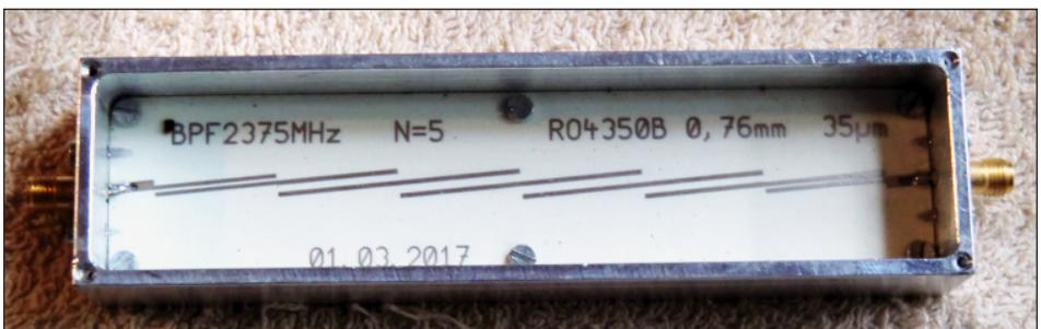
*Bild 57: Die fertige Schaltung im gefrästen Alugehäuse. Bei den Platinenabmessungen von 30 mm x 130 mm wird das schon ein stattliches Teil*
