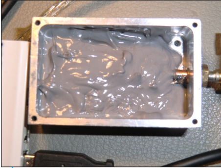
Bild 20: Das Gehäuse wird mit elektrisch nichtleitender Wärmeleitpaste geflutet; das senkt das Temperaturniveau durch verbesserte Kühlung und die Frequenzkonstanz des Quarzoszillators profitiert deutlich davon
