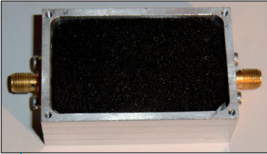
Bild 27: Sobald man jedoch die Ursache ermittelt hat, hilft der altbekannte dämpfende Schaumstoff weiter (siehe Text)
