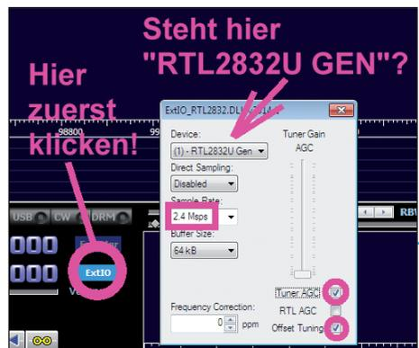
*Bild 5: Die „ExtIO“-Einstellung muss genau geprüft und Fehlendes aktiviert werden (siehe Text)*
