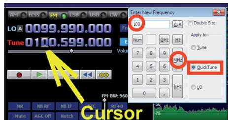
Bild 8: Die Frequenz-GrobEinstellung ist schon etwas trickreich und beginnt mit einem Mausklick in die Frequenzanzeige, gefolgt von der Eingabe der ersten Ziffer des Frequenzwertes; dann erst öffnet sich dieses Menü (siehe Text)
