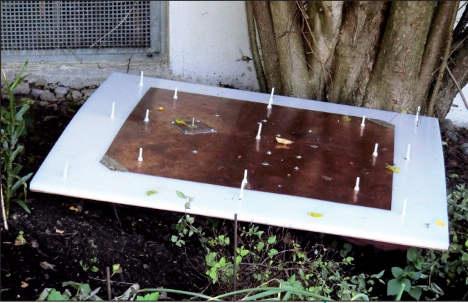
Bild 21: Jetzt wird es ernst! Die Antenne wird im Garten vor der Kellerwerkstatt aufgebaut, das Antennenkabel (5 m RG58) verschwindet durch das Kellerfenster ...
