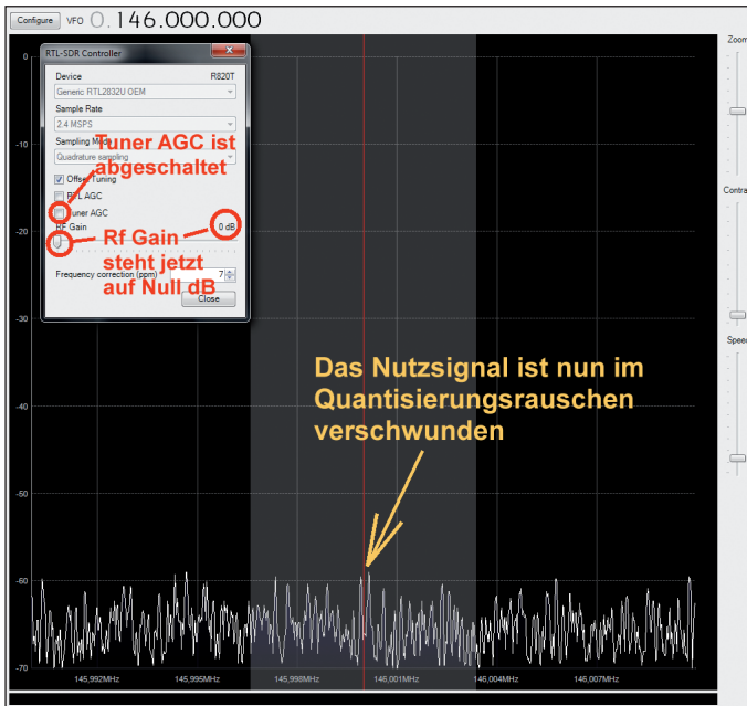
Bild 6: Bei weiterer Reduktion um 20 dB auf insgesamt 50 dB Verstärkungsmin- derung ist das Nutz- signal im Rauschen verschwunden
