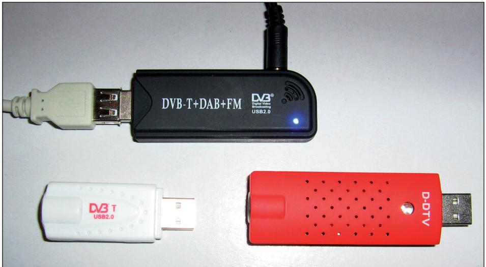
Bild 1: Einige Varianten von DVB-T USB-Sticks in unterschiedlicher Bauform
