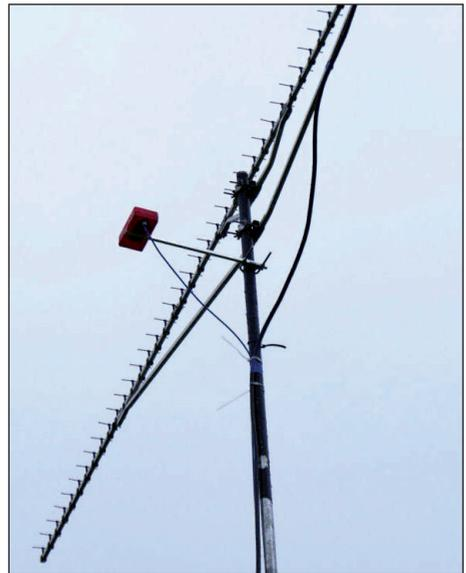
*Bild 2: Die Außeneinheit betriebsbereit am Antennenmast montiert*
