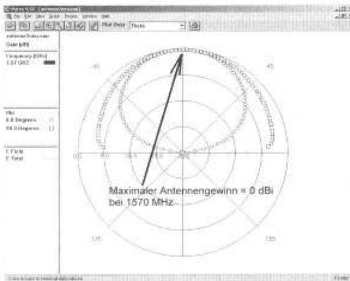
Bild 23: Richtdiagramm samt „Gewinn“ des runden Patches bei 1570 MHz (Siehe Text)
