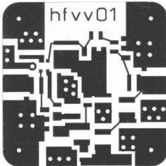
**Bild 20: Platinenlayout für FR4-Material mit 1,5 mm Dicke, Außenmaße 30 mm x 30 mm**
