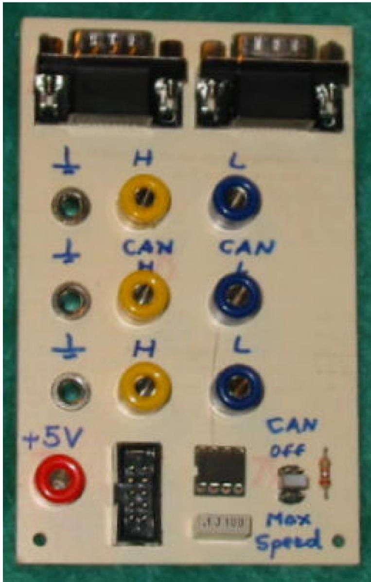
Sie ist im üblichen Zusatzplatten-Format unseres Boards gestaltet und enthält im oberen Teil die Anschlüsse für den CAN – Bus (wir brauchen zwei, wenn wir mehrere CAN-Teilnehmer am Bus haben wollen, nämlich „Zugang“ und „Abgang“.
