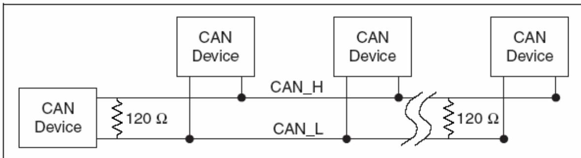
Es handelt sich um einen 2-Leiter-Bus (mit zusätzlicher Ground-Leitung), an den alle Teilnehmer völlig gleichberechtigt und parallel angeschlossen sind. Dieses symmetrische System (das nur auf den **Spannungsunterschied** zwischen beiden Leitungen reagiert!) zeichnet sich besonders durch hohe Störsicherheit aus und ermöglicht die Kommunikation entweder bis zu einer Entfernung von 1km mit max. 50 Kilobit / sec oder bis zu 40m mit max. 1Megabit / sec.
