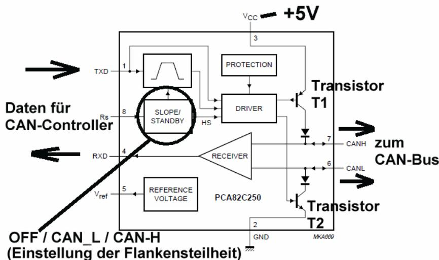
Links wird der nötige CAN-Controller angeschlossen -- er liefert die zu übertragenden Daten als **TTL-Signal** (0V = logische Null, +5V = logische Eins).
