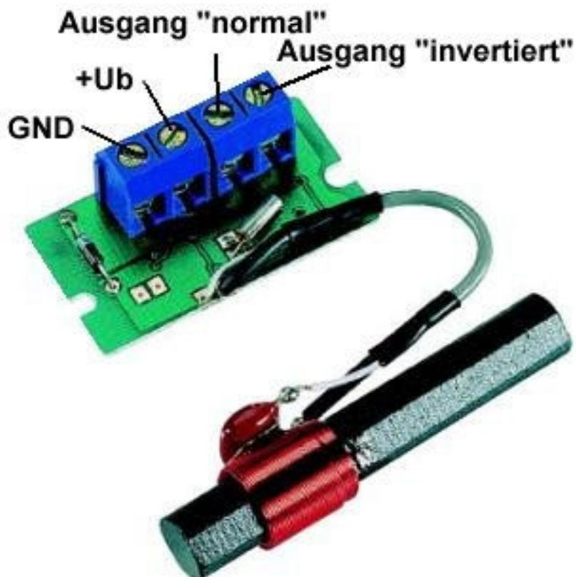
Unter Verwendung eines für ca. 12 Euro käuflichen DCF77-Empfänger-Moduls der Firma Conrad erfolgt die Auswertung der übertragenen Zeit- und Datumsinformationen mit unserem ATMEL-ATM1- Board.
